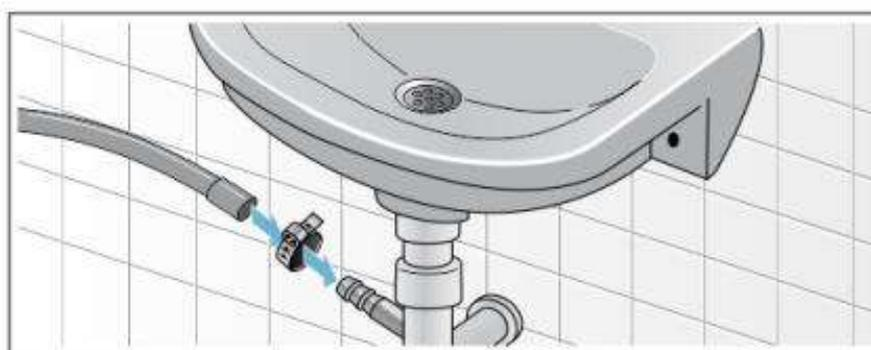
Закрепите сливной шланг на сифоне раковины с помощью хомута для шланга диаметром  $\approx 0,9-1,6$  дюйма (20-44 мм)
