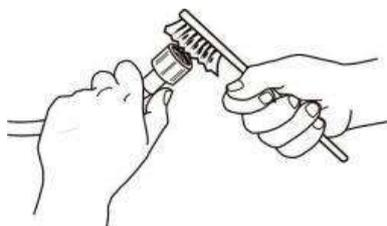
3. Теперь вручную отвинтите шланг подачи воды на задней панели прибора. Плоскогубцами выньте сетчатый фильтр из клапана подачи воды на задней панели прибора и тщательно очистите его.
