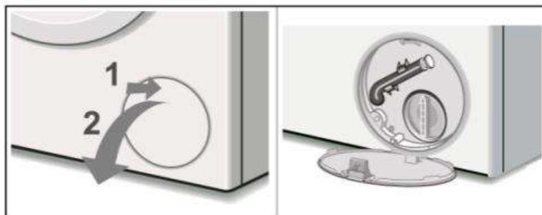
4. Используйте выдвижной сливной шланг, расположенный в отверстии для доступа к насосу, чтобы слить оставшуюся воду в подходящую емкость (можно слить до 5,3 галлона США/20 литров воды). Снимите уплотнительный колпачок со шланга, положите шланг на борт контейнера и дайте воде полностью стечь из барабана. Когда закончите, установите уплотнительный колпачок на конец шланга и верните шланг на место хранения.
